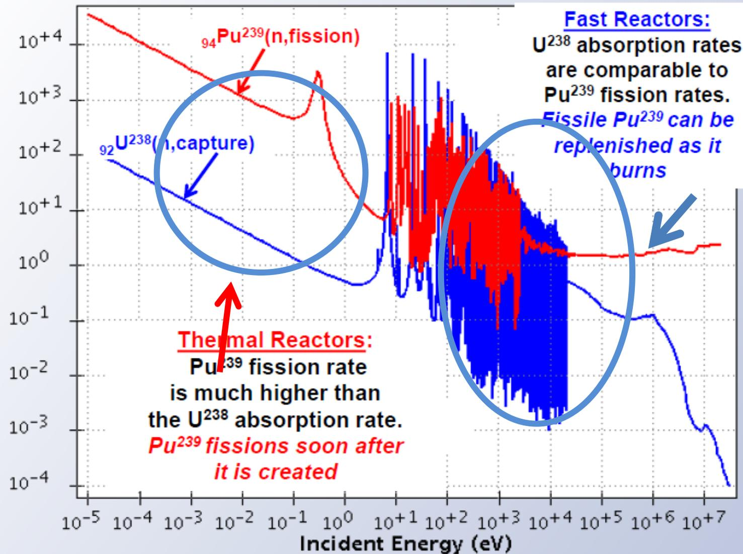
Per migliorare l'uso del combustibile si usano neutroni veloci per creare il fissile  $^{239}Pu$ .
