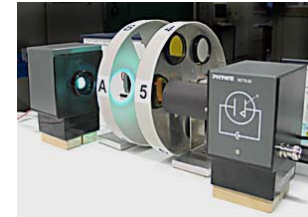
La Diffrazione Elettronica Osserva la diffrazione degli elettroni da un film di grafite Luogo: Universität der Bundeswehr München , Germania Pubblicazione: 2002
