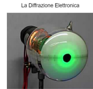
La Diffrazione Elettronica Osserva la diffrazione degli elettroni da un film di grafite Luogo: Universität der Bundeswehr München , Germania Pubblicazione: 2002
