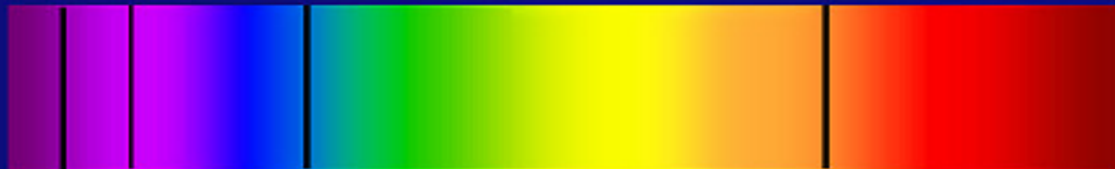
Spettro di ASSORBIMENTO dell'idrogeno
