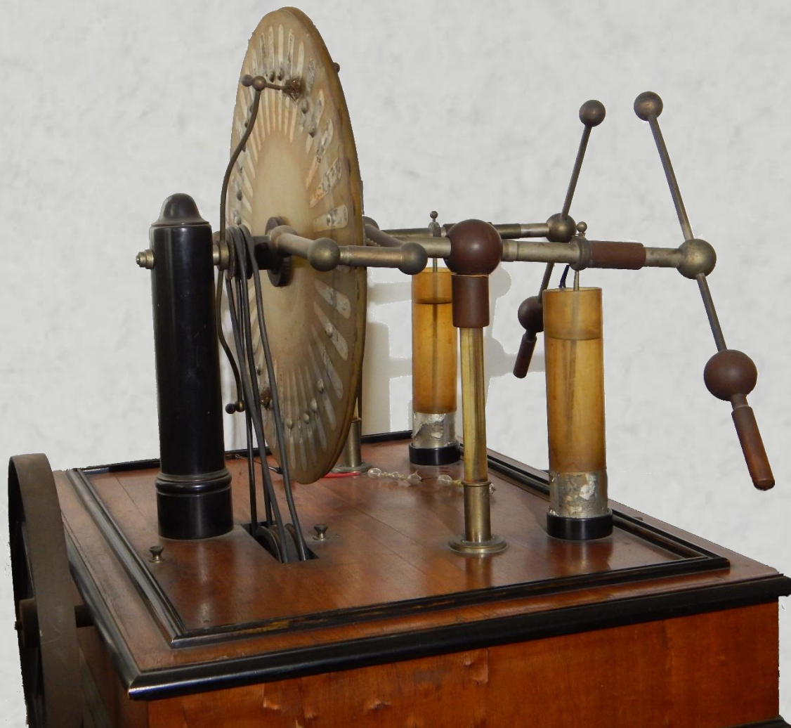
Macchina elettrostatica di James Wimshurst 1883
