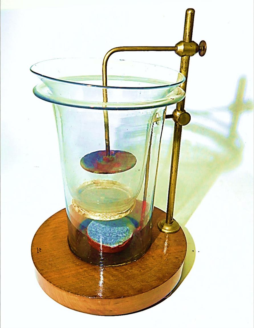
Si può facilmente ottenere una ddp da due elettrodi di Cu e Zn purché siano immersi in una soluzione contenente elettroliti.
