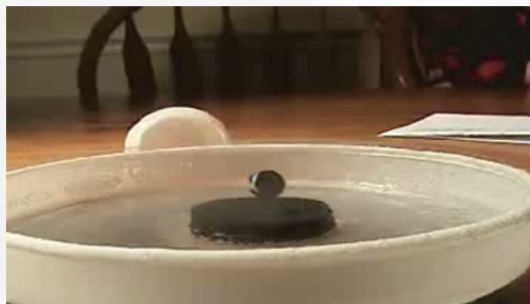
Levitazione dovuta a superconduttori ad alta temperatura critica
