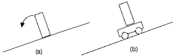
Figura 8. (a) Il mattone, appoggiato sul tavolo inclinato, si ribalta. (b) Posto su un carrello che scende liberamente, resta in equilibrio.
