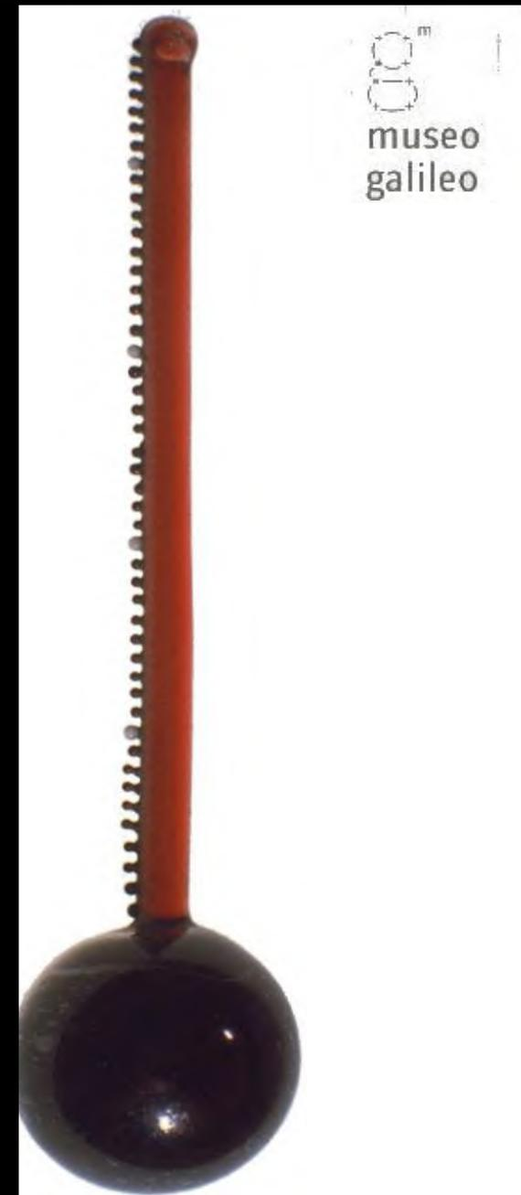
Il primo suggerimento di usare due **termini fixi** per la scala si deve a **Sebastiano Bartolo (1679)** che impiegò per il vecchio termoscopio ad aria la neve e l'acqua bollente, corrispondenti, rispettivamente, al grado di **“freddo massimo”** e di **“calore massimo”** e ritenuti **“punti fixa et ubique immutabilia”**, mentre il grado relativo alla temperatura ambiente (**“communis ambiens”**) e alla temperatura corporea venivano considerati variabili.
