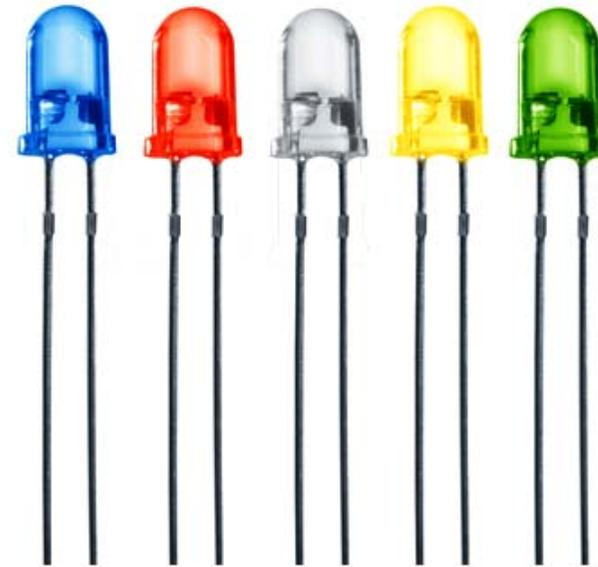
Il colore, ossia la lunghezza d'onda della luce emessa, dipende dal gap di energia del materiale semiconduttore secondo la relazione
